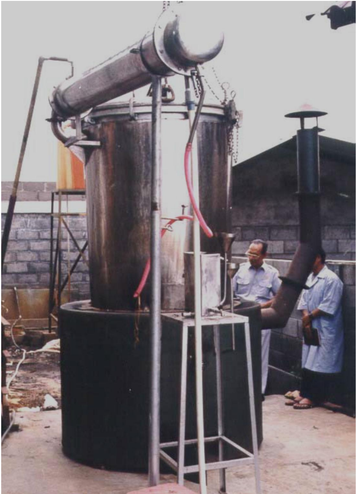
Gambar 6. Alat penyulingan untuk menghasilkan minyak Seraiwangi (Rusli 2008)
