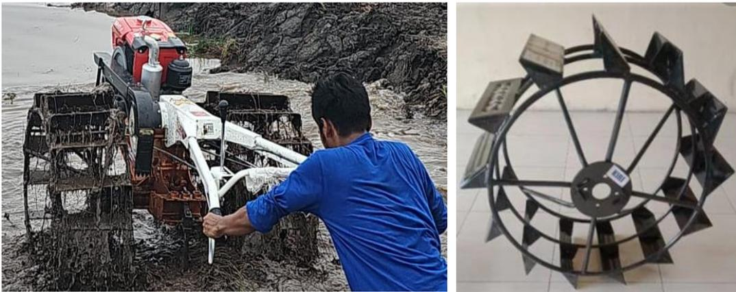
Gambar 31 TR 2 dengan roda besi berdiameter besar dengan sirip lebar untuk lahan dengan kekerasan tanah baik/cukup
