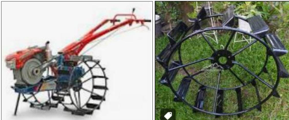
Gambar 30 TR 2 dengan roda besi standar direkomendasikan untuk lahan dengan kekerasan tanah tinggi
