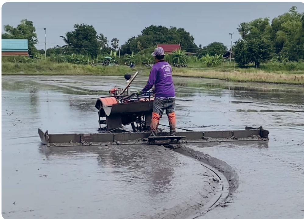
Gambar 7. Traktor roda dua yang dilengkapi dengan perata lumpur
