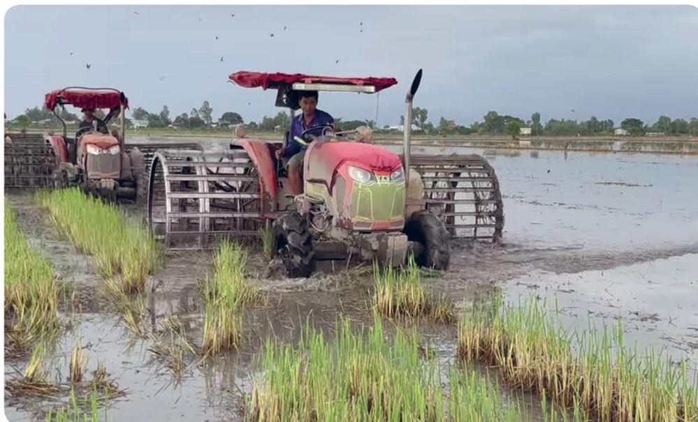
Gambar 8. Modifikasi traktor roda empat untuk lahan dalam
