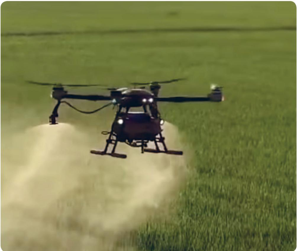
*Gambar 10. Proses penyemprotan pestisida menggunakan drone sprayer*
