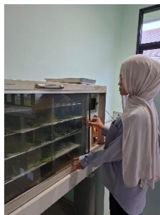
Gambar 4. Pengeringan Daun Sirih Menggunakan Oven Suhu 45°C
