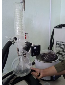
Gambar 4.4 Proses Evaporasi Ekstrak Kencur Hitam dengan Rotary Evaporator Sumber: Dokumentasi Pribadi, 2026
