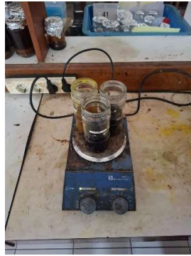
Evaporasi menggunakan hotplate dengan suhu 50°C.
